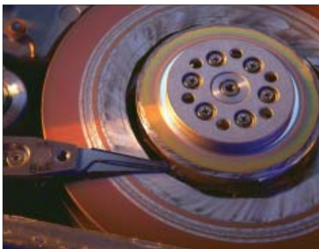
Rys. 2. Uszkodzenie głowicy. Źródło: IBAS www.ibas.com
