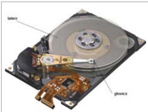
Rys. 1. Budowa twardego dysku. Źródło: PC Guide. www.pcguid.com . Oryginał: Western Digital Corporation
