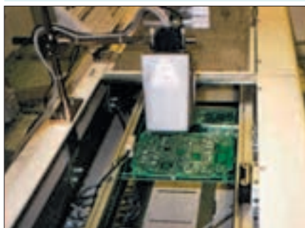
Fot. 2. Kod Matrix 2000 w produkcji płytek SMD. (Fot. Datalogic GmbH)
