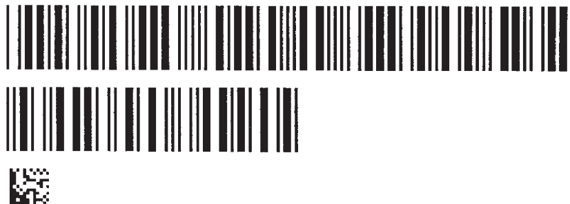
Rys. 1. Kody kreskowe w konfrontacji z kodem DataMatrix. Źródło: Datalogic GmbH
