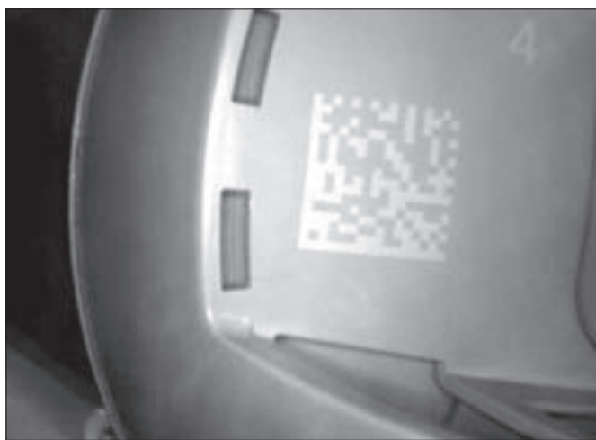
Fot. 6. Bezpośrednie znakowanie części w mechanicznych konstrukcjach – Direct Part Marking (DPM). (Fot. Datalogic GmbH)
