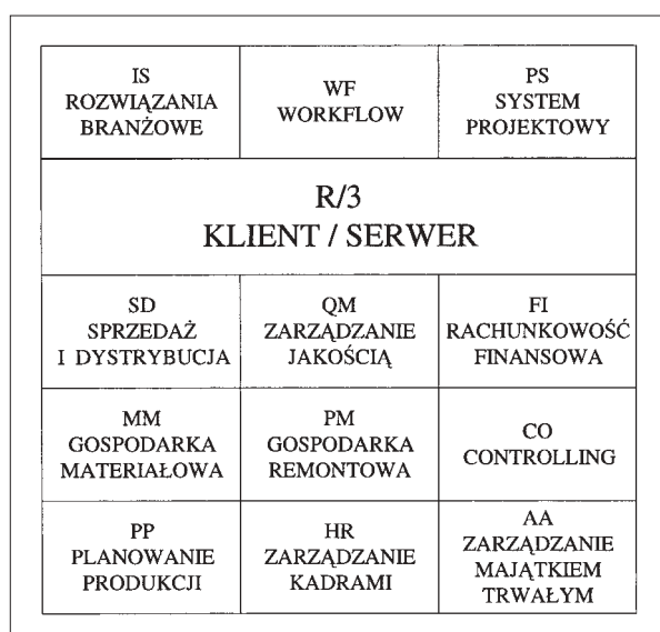
Rys. 1. Elementy systemu R/3. Źródło: Opracowanie własne
