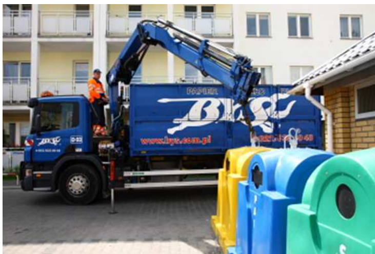
Rys. 2. Samochód do transportu odpadów z HDS [21]
