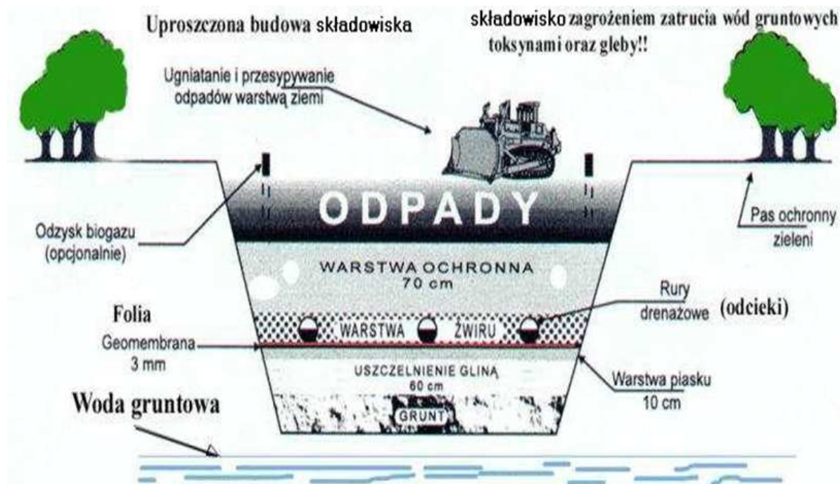
Rys. 3. Uproszczona budowa składowiska odpadów [22]
