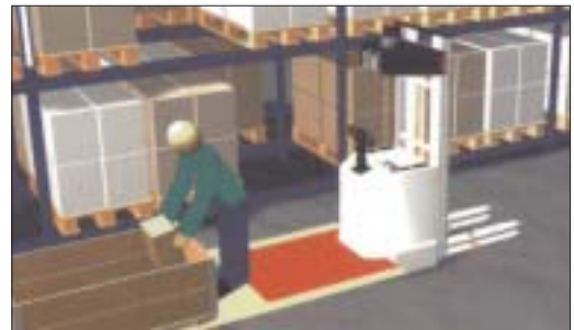
Rys. 6. Dolny system zapewnienia bezpieczeństwa pracy: a) jazda w kierunku przeszkody, b) naruszenie żółtej strefy bezpieczeństwa, c) całkowite zatrzymanie wózka w momencie naruszenia strefy czerwonej
