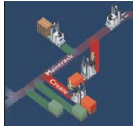
Rys. 2. Programowanie pracy wózka – droga główna – kolor fioletowy, – droga dojazdowa – kolor zielony, – droga aktualnie programowana – kolor czerwony
