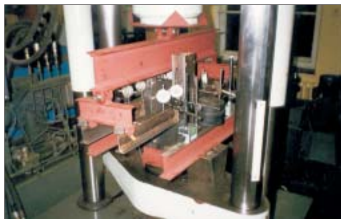
Rys. 12. Stanowisko do badań sztywności zaczepek. Źródło: opracowanie własne
