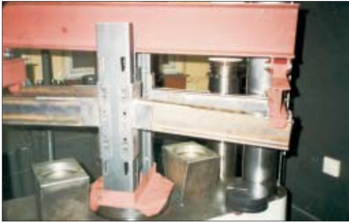
Rys. 13. Odcinki rygli z zaczepami zamontowane na stanowisku badawczym (stan po pełnym obciążeniu). Źródło: opracowanie własne.
