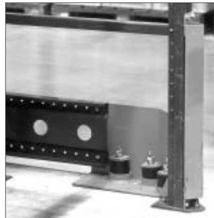
Ryc. 32. Wolnostojąca ochrona ramy, montowana w narożach rzędu regału paletowego. Zobacz również ryc. 1 w I części artykułu („Logistyka” nr 1/2001 s. 33)
