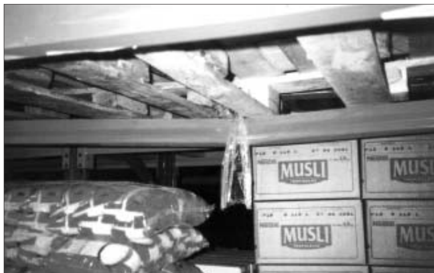
Ryc. 30. Przykład tylnej belki z trzema paletami po poważnej kolizji w skutek zbyt dużego pochylenia widel i zbyt niskiego wjazdu do regału. Palety jeszcze "normalnie" leżą na belce
