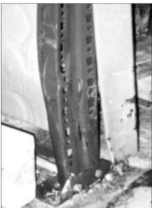
Ryc. 29. Przykład poważnego uszkodzenia słupa. Regał był "normalnie" używany
