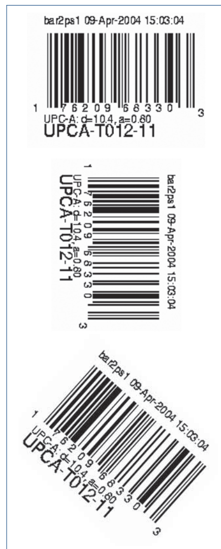
Rys. 2. Obrót odczytywanych kodów o 0°, 90° i 45°.
