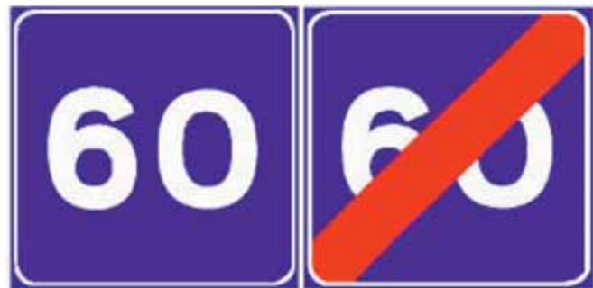
Rys. 9. Włoskie znaki prędkości rekomendowanej: a) początku, b) końca, Velocità consigliata, Fine velocità consigliata [10].
