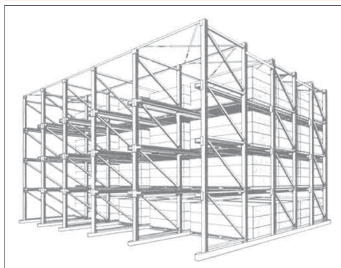
Rys. 12. Regały stałe wspornikowe z podporami wspornikowymi zablokowane dwustronnie. Źródło: materiały prospektowe.
