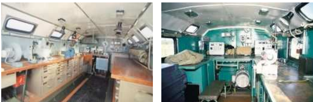
Rys. 10. Przykładowe wnętrza mobilnych warsztatów (widoczne stoły warsztatowe oraz specjalistyczne urządzenia rozmieszczone w ich wnętrzu)
