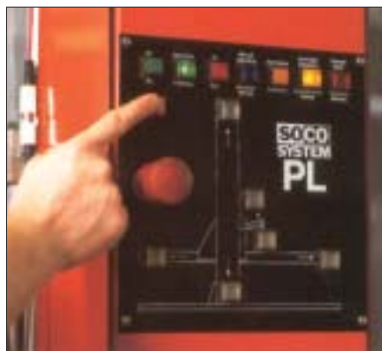
Rys. 2. Panel sterowania wyposażony w urządzenie awaryjne
