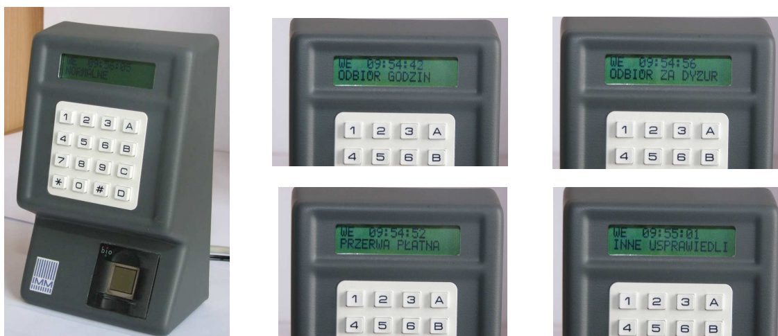
Rys. 5. Czytnik linii papilarnych IMMSkan 300 opracowany przez Instytut Maszyn Matematycznych
