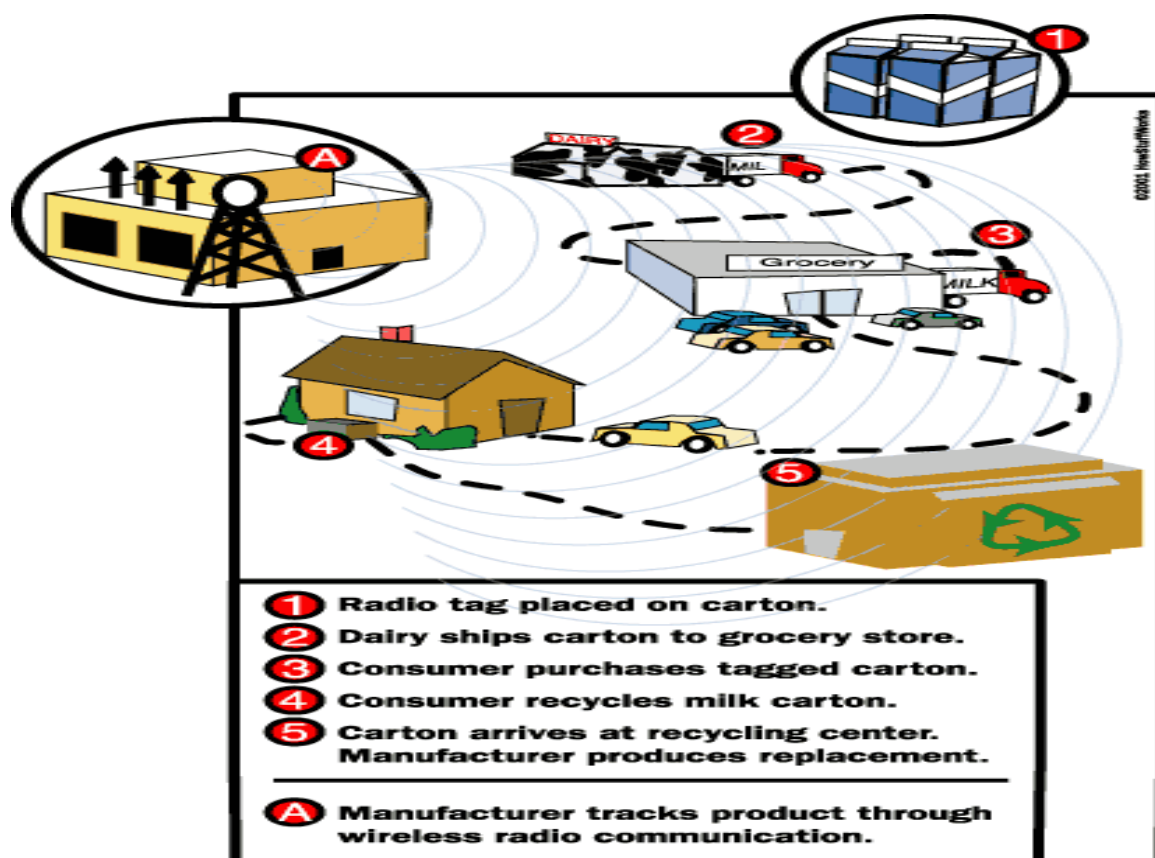
Rys. 2. Przebieg procesu obiegu produktu przy zastosowaniu technologii RFID
