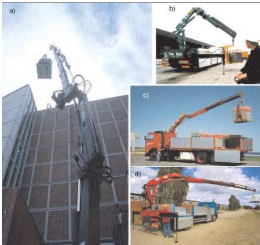
Rys. 1. Rozładunek pojazdu u odbiorcy a) transport z dostawą „na dach”, b-d) ustawienie palety w miejscu dogodnym dla klienta
