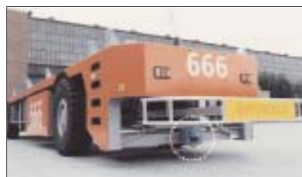
Rys. 10. Kontenerowiec portowy z zainstalowanym systemem nawigacyjno-antykolizyjnym
