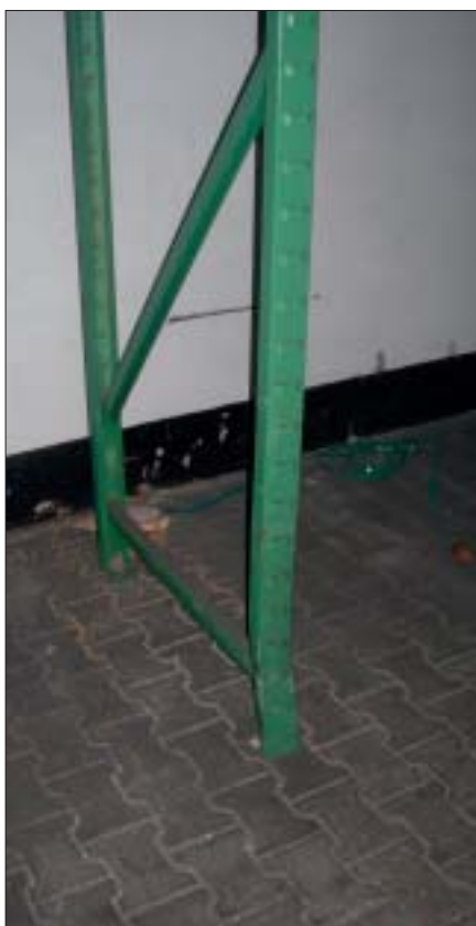
Fot. 4. Odształcone podczas eksploatacji elementy czółowych ram nośnych regału ramowego dwurzędowego, które nie zostały osłonięte odbojnicą (Fot. A. Wojciechowski)
