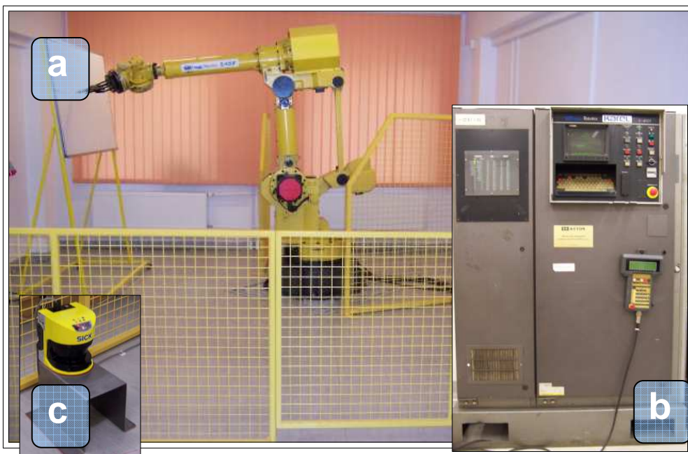
Rys. 1. Zrobotyzowane stanowisko laboratoryjne a) Stanowisko robocze; b) Kontroler R-H; c) Skaner SICK S3000
