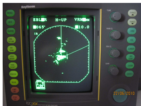
Rys. 3 Obraz radaru impulsowego na zakresie 1,5 Mm
