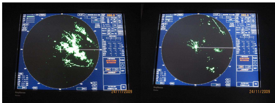
Rys. 5 Opady atmosferyczne na radarze impulsowym NSC 34
