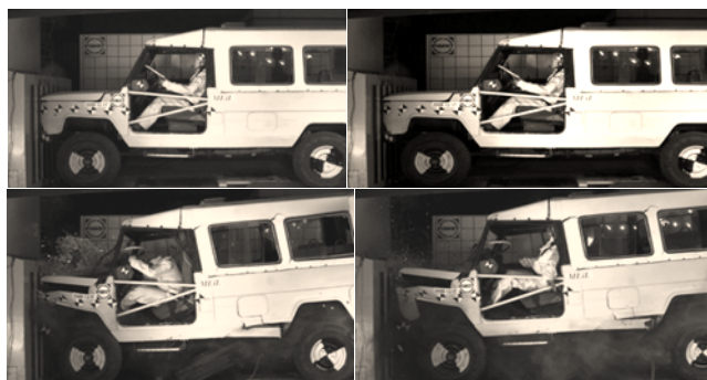
Rys. 5. Kolejne fazy uderzenia w sztywną przeszkodę z prędkością 44 km/h
