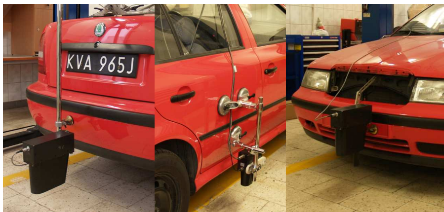
Rys.1. Rozmieszczenie głowic pomiarowych na samochodzie badawczym
