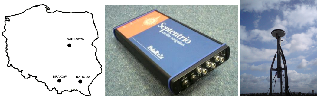
Rys. 3. Lokalizacja stacji monitorujących GNSS/EGNOS i podstawowe elementy
