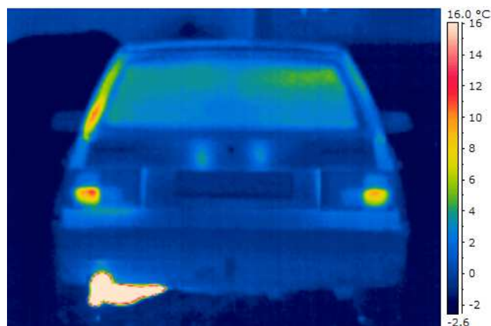
Rys.5. Tył samochodu (widoczne straty ciepła po lewej stronie kłapy bagażnika)
