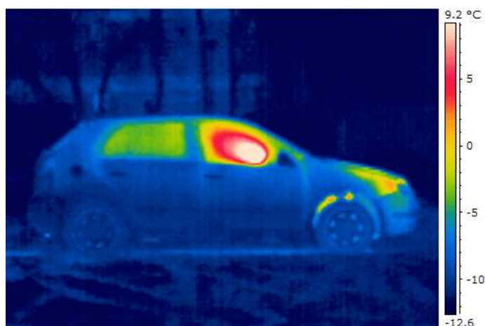
Rys.1. Zdjęcie termowizyjne samochodu (widoczne straty ciepła w miejscach łączących drzwi samochodu z nadwoziem)
