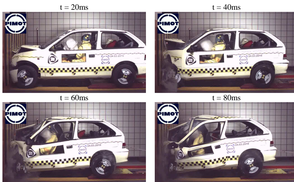
Rys. 2. Wybrane kadry filmu obrazujące przebieg zgniatania nadwozia
