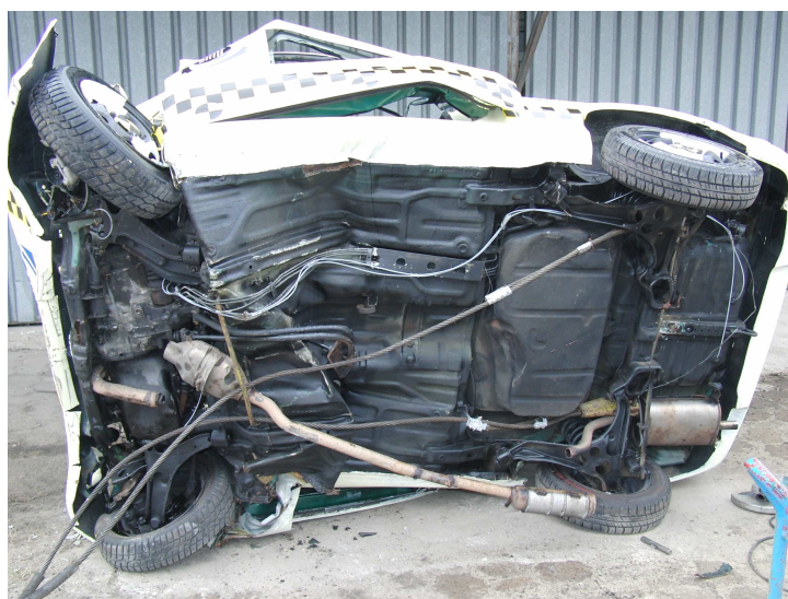
Rys. 5. Odkształcenia płyty podłogowej suzuki swift po zderzeniu ze ścianą
