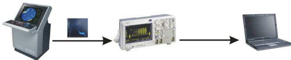
Rys 2. Zestaw pomiarowy do rejestracji pierwotnego sygnału wizyjnego z radaru nawigacyjnego (opracowane na podstawie [2])
