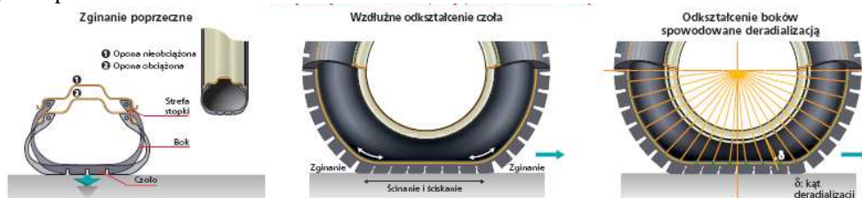
Rys. 4. Odkształcenia opony podczas toczenia
