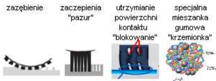
Rys.3. Mechanizm działania opon zimowych
