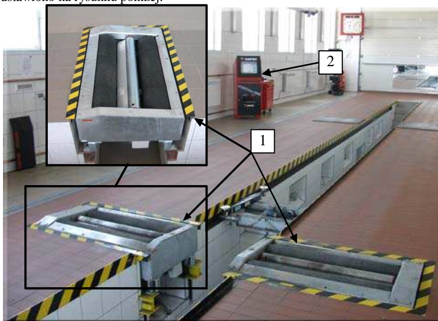
Rys. 5. Stanowisko rolkowe typu BDE 4004P-0/M (1 – zestawy rolek napędowych, 2 – centralna jednostka sterująco-wskazująca)
