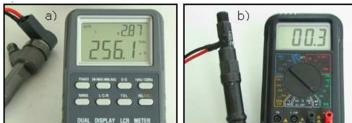
Rys. 2. Pomiar indukcyjności (a) i rezystancji (b) cewki wtryskiwacza elektromagnetycznego [3]
