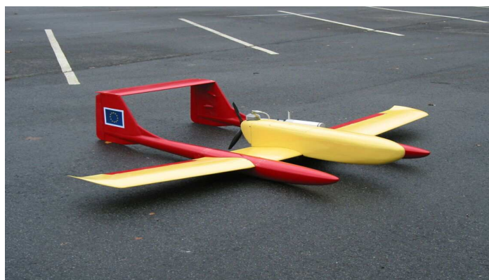
Rys. 13. Miniaturowy system bezzałogowej powietrznej kontroli statków rybackich RYBAK Dane techniczne: rozpiętość - 2.7, max masa startowa - 18 kg, prędkość lotu 90 - 150 km/h, promień operowania - 20 km, wysokość lotu - 600 m, długotrwałość - 1.5 h, wyposażenie:
