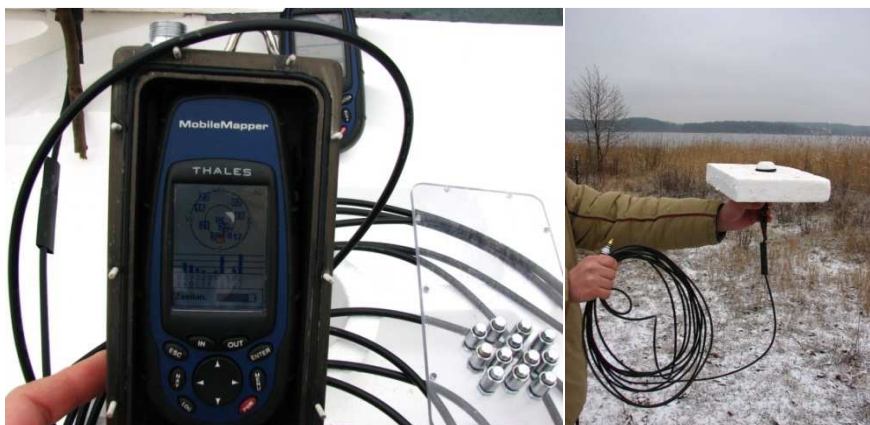
Rys. 2. Zestaw GPS: Thales Mobile Mapper w obudowie do prac pod wodą. Antena GPS
