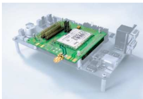
Rys.1. Płyta główna CS1139B i moduł GE863-GPS
