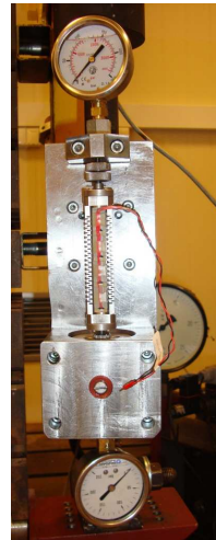
Rys.2. Stanowisko do badań właściwości tłumików: a) widok stanowiska, b) tłumik PZ
