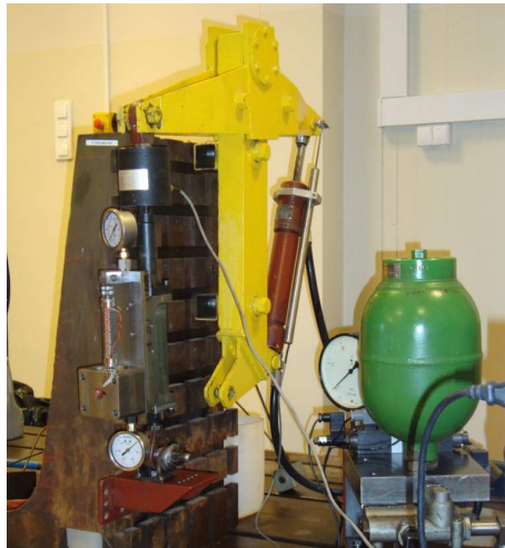
Rys.2. Stanowisko do badań właściwości tłumików: a) widok stanowiska, b) tłumik PZ
