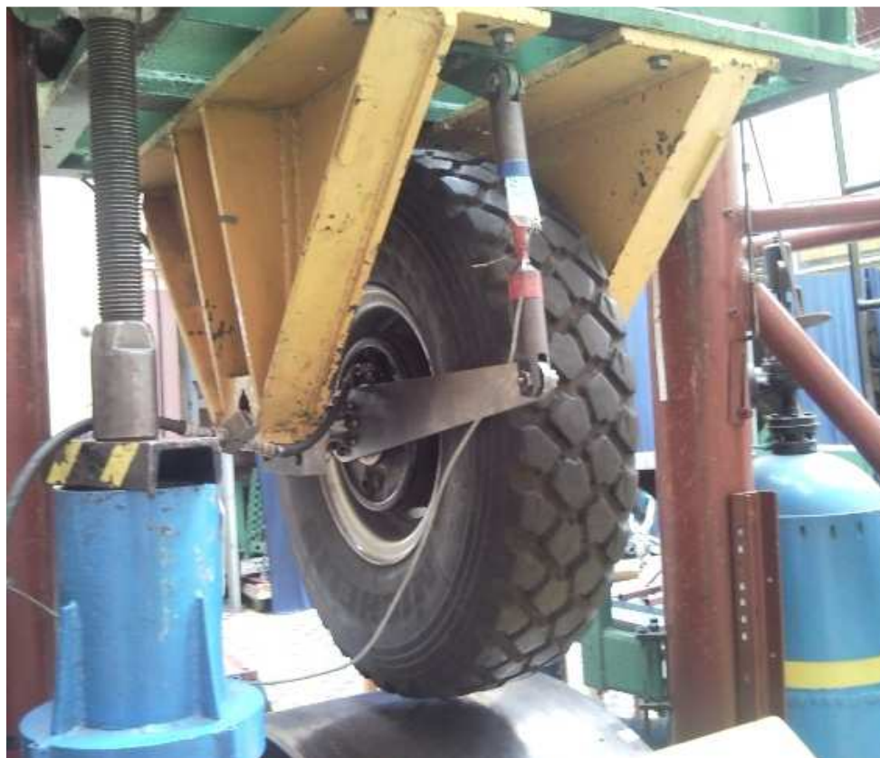
Rys. 7. Koło z hamulcem zainstalowane na stanowisku badawczym
