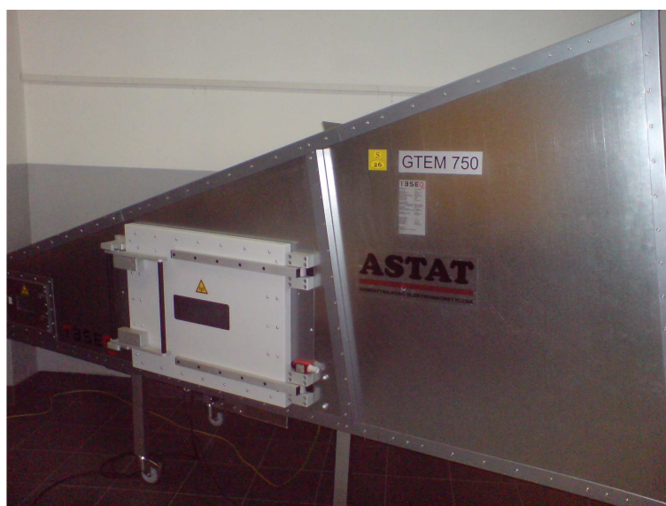
Rys. 1. Komora GTEM 750, w której prowadzono badania
