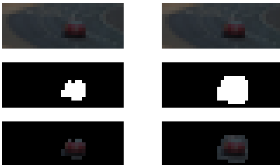
Rys. 2 Przykład selekcji obrazu pojazdu (górny wiersz) zwykłą maską (środkowy wiersz z lewej) oraz maską z dylatacją (środkowy wiersz z prawej).
