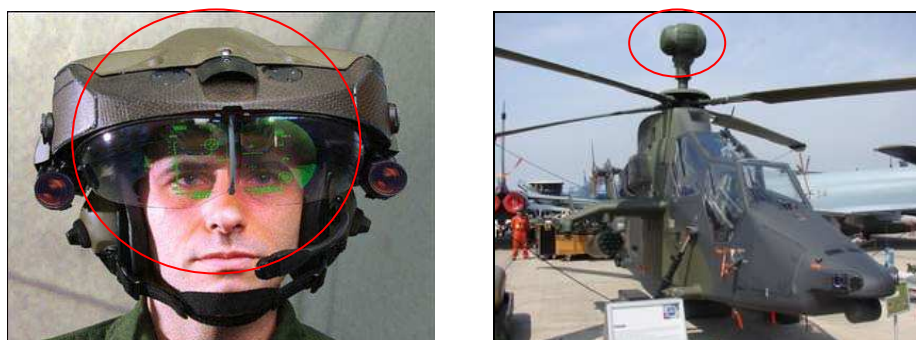
Rys.1. Widok hełmu z elementami systemu celowniczego TopOwl (po lewej) i zabudowanej głowicy obserwacyjno-celowniczej (po prawej) dla śmigłowca TIGER HAC
