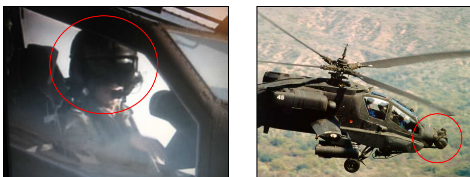
Rys.2. Widok nahełmowego wyświetlacza parametrów celowniczych IHADSS (po lewej) i głowicy obserwacyjnej PNVS/TADS (po prawej) dla śmigłowca AH-64 APACHE
