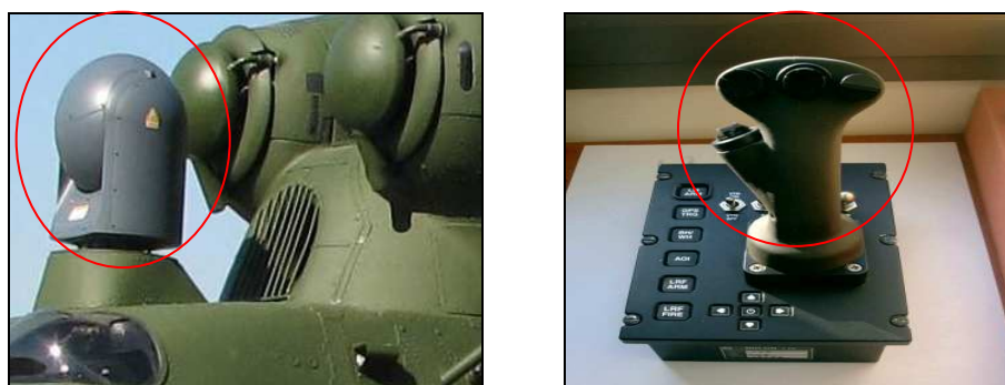
Rys.5. Widok głowicy obserwacyjno-celowniczej TOPLITE (po lewej) i układu ręcznego sterowania położeniem głowicy (po prawej) dla śmigłowca W-3PL GŁUSZEC
