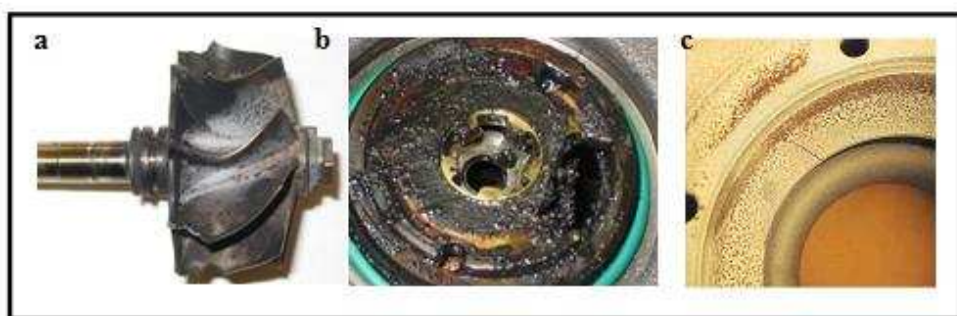
Rys.8. Uszkodzenia elementów turbosprężarek wywołane zbyt wysoką temperaturą spalin: zniekształcone łopatki koła turbiny a), nagar olejowy zgromadzony w korpusie środkowym b), pęknięcie korpusu turbiny c) [6], [3]
