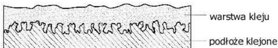
Rys.1. Schemat ideowy adhezji mechanicznej w procesie klejenia [14]
