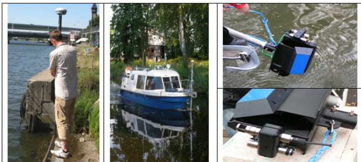
Rys. 5. Pomiar linii brzegowej odbiornikiem GPS Trimble, jednostka HYDROGRAF XXI z zamontowaną sondą interferometryczną oraz głowica tej sondy z dwoma przetwornikami 250 kHz.
