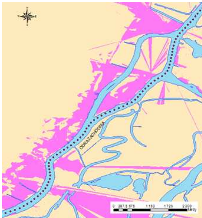
Rys. 3. Zastosowanie analizy widoczności do wyznaczania zakresu pokrycia komórki. Przewidywane pokrycie radarowe oznaczono kolorem fioletowym.
