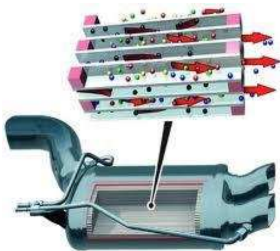
Rys.1. Budowa filtra cząstek stałych (źródło-internet)
