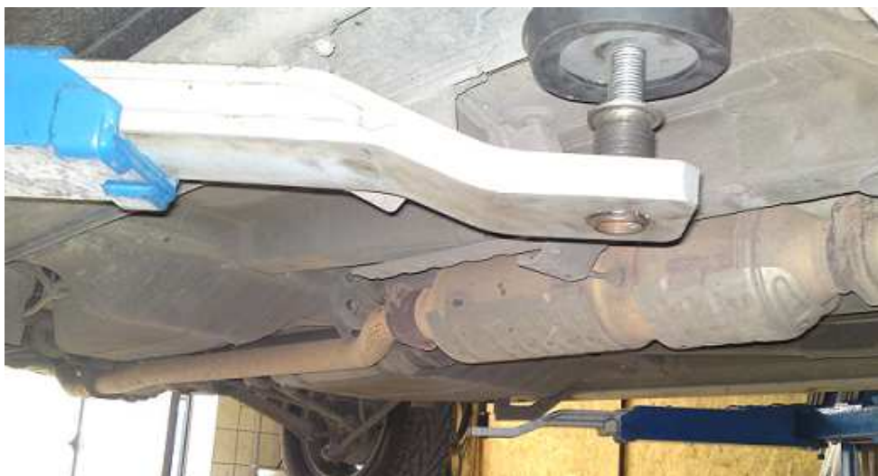
Rys.2. Filtr cząstek stałych w samochodzie Hyundai (źródło własne)
