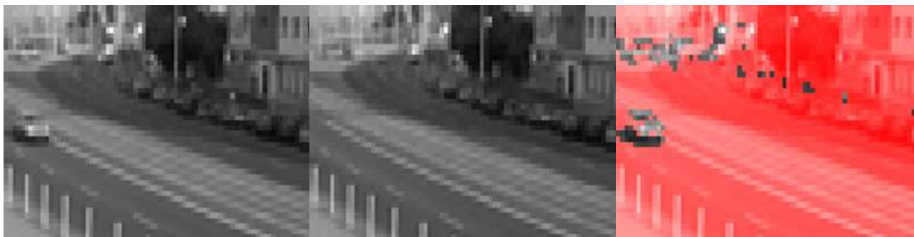
Rys.5. Przykładowy obraz wejściowy (klatka sekwencji testowej), referencyjny obraz tła oraz obraz z zaznaczonymi pikselami sklasyfikowanymi jako tło
