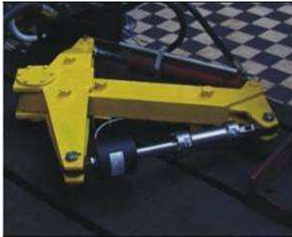
Rys. 2. Stanowisko do badań własności tłumików MR
