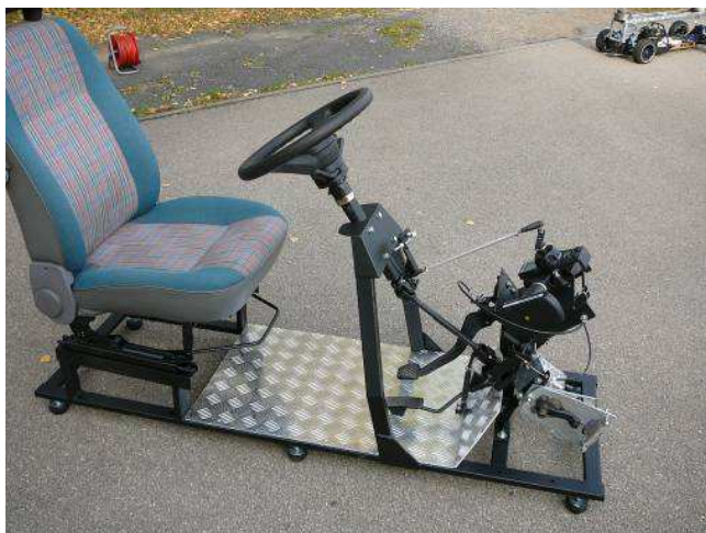
Rys.13. Widok stanowiska sterowniczego mobilnego modelu samochodu. Po lewej dla sterowania z kontaktem wzrokowym, po prawej dla sterowania z obrazu na monitorze
