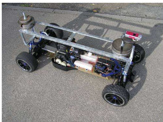
Rys.12 Widok mobilnego modelu badawczego z obciążnikami i kamerą teletransmisji obrazu do stanowiska sterowniczego
