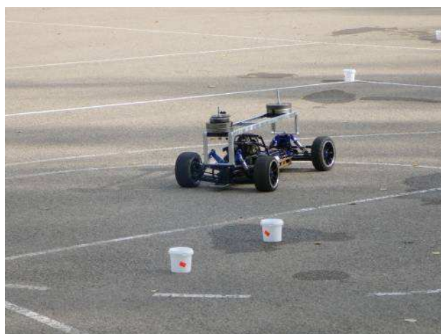
Rys.12 Widok mobilnego modelu badawczego z obciążnikami i kamerą teletransmisji obrazu do stanowiska sterowniczego
