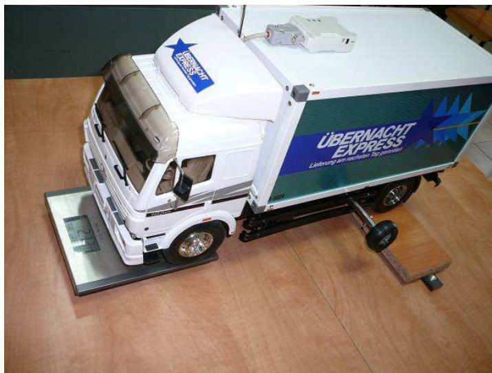
Rys.9. Wyznaczanie środka masy metodą ważenia nacisków osi
