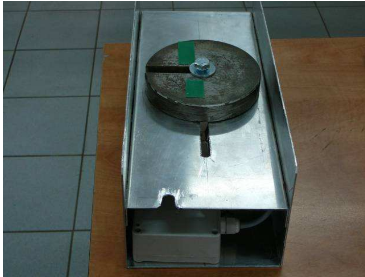
Rys.7. Pojemnik z obciążnikiem do określania położenia środka masy
