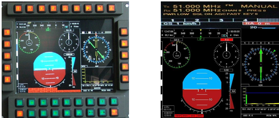
Rys. 4. Widok monitora wielofunkcyjnego (po lewej) z elementami zobrazowania systemu łączności (po prawej) zabudowanego na śmigłowcu W-3PL
