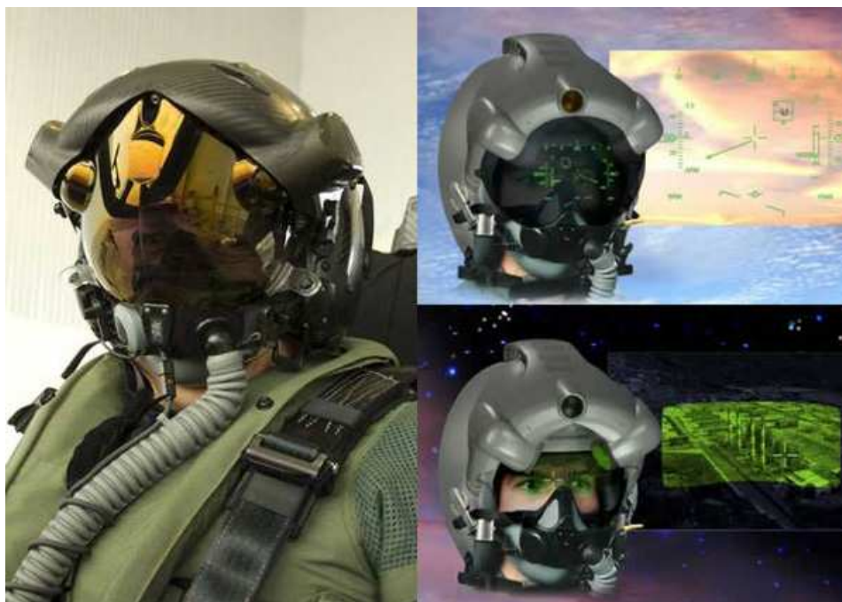
Rys. 2. Zobrazowanie danych na wyświetlaczu nahlmowym samolotu F-35 (dzień - noc)
