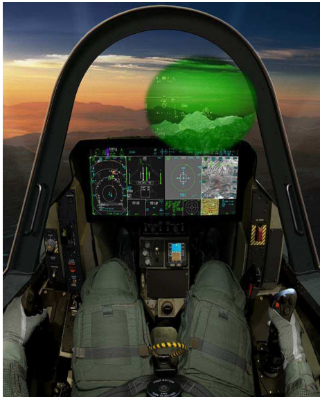
Rys. 1. Kabina samolotu F-35 (po lewej), system zobrazowania nahełmowego dla samolotu F-35 (po prawej)
