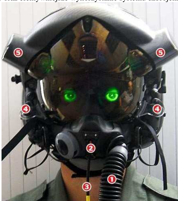
Rys. 3. Hełm z wyświetlaczem HMDS II Generacji samolotu wielozadaniowego F-35
