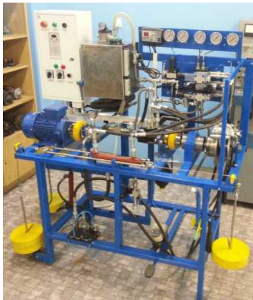
Rysunek 8. Stanowisko pomiarowe Układu hydraulicznego maszyny roboczej
