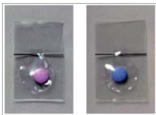
Rys. 9. Wskaźnik Ageless Eye firmy Mitsubishi Gas Chemical (kolor różowy – brak tlenu, kolor niebieski oznacza zawartość tlenu w opakowaniu na poziomie 21%). Źródło: www.mgc.co.jp
