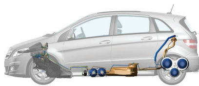
Fot. 4. Umieszczenie zbiorników CNG w mercedesie Klasy B (materiały informacyjne grupy Hexagon Composites).
