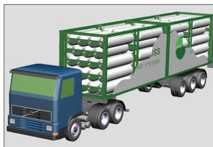
Fot. 5. SMARTSTORE – konstrukcja oparta o standardowy kontener (20 bądź 40 stopowy), ze zbiornikami o pojemności 450 l we wnętrzu – do 40 sztuk (materiały informacyjne grupy Hexagon Composites).
