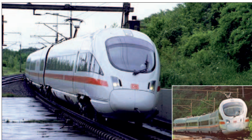
Rys. 3. ICE T – z wychylnym pudłem
