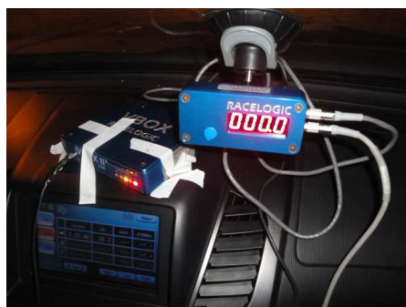
Rys. 7. Urządzenie Racelogic do badań skuteczności układu hamulcowego przyczepy
