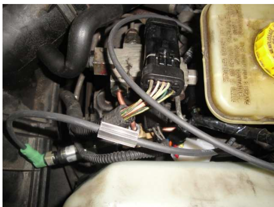
Rys. 3. Przetwornik ciśnienia hydraulicznego zamontowany na obwodzie pompy hamulcowej samochodu Jeep Grand Cherokee
