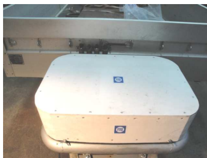
Rys. 6. Pokrywa układu hamulcowego PIMR, z tyłu widoczne gniazda kontrolne, wymagane przepisami homologacyjnymi
