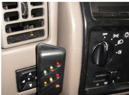
Rys. 4. Panel kontrolny z diodami LED sygnalizującymi pracę układu hamulcowego PIMR, zamontowany na desce rozdzielczej samochodu Jeep Grand Cherokee
