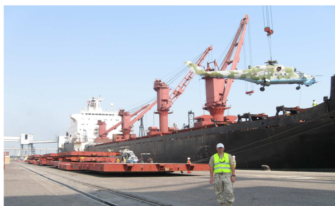
Rys. 6. Załadunek śmigłowca Mi-24 na pokład statku Blue Oxygen, za pomocą żurawia Źródło: http://www.mmszczecin.pl/rep/newsph/21189/39079.3.jpg , (02.06.2009)
