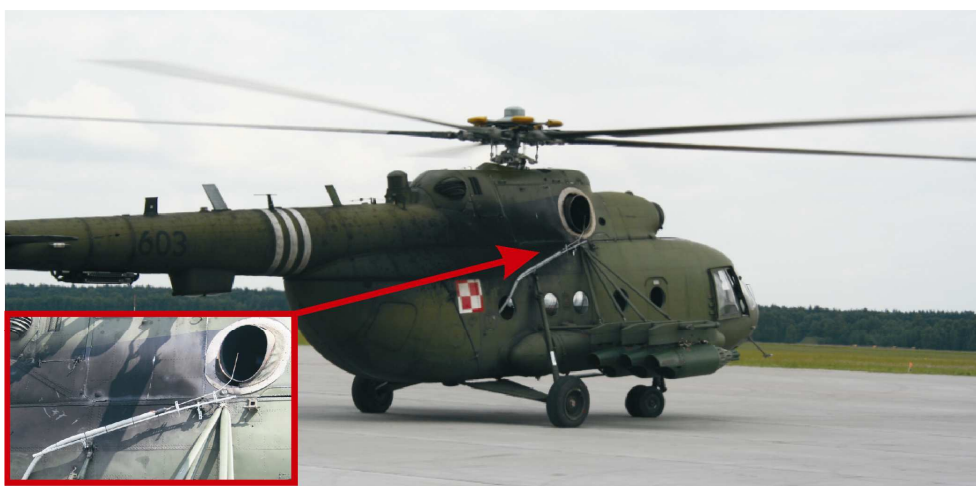
Rys. 3. Miejsce zamocowania sondy poboru spalin na śmigłowcu Mi-17
